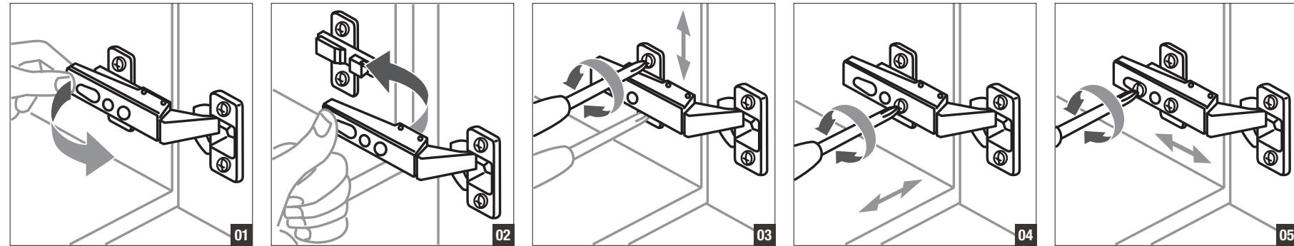
**DE:** Feineinstellung **EN:** Precision adjustment **FR :** Réglage de précision **NL:** Fijninstelling **ES:** Ajuste fino **CS:** Přesné nastavení **HU:** Finombeállítás **DA:** Finjustering **IT:** Regolazione **PL:** Nastawianie **RO:** Reglaj de finețe **RU:** Точная регулировка **SK:** Presné nastavenie **SL:** Natančne nastavitev **TR:** Hassas ayar **ZH:** 精调
