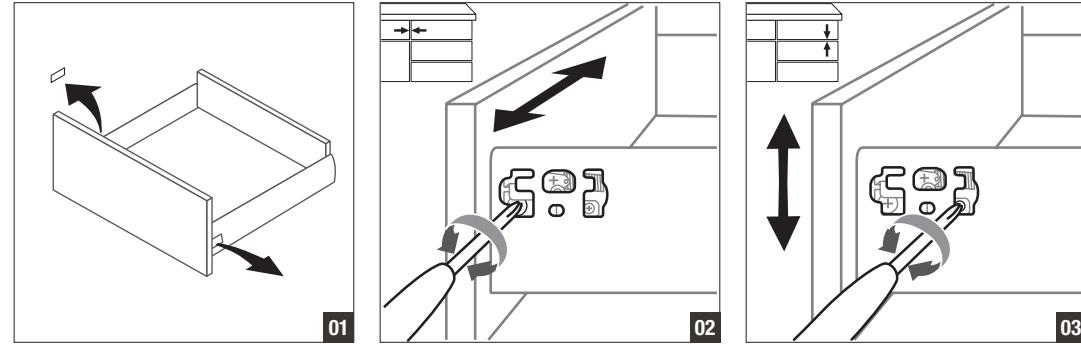
**DE:** Feineinstellung **EN:** Precision adjustment **FR :** Réglage de précision **NL:** Fijninstelling **ES:** Ajuste fino **CS:** Přesné nastavení **HU:** Finombeállítás **DA:** Finjustering **IT:** Regolazione **PL:** Nastawianie **RO:** Reglaj de finețe **RU:** Точная регулировка **SK:** Presné nastavenie **SL:** Natančne nastavitev **TR:** Hassas ayar **ZH:** 精调
