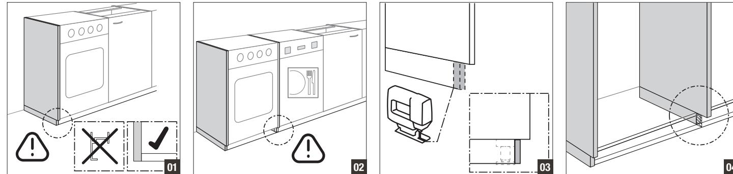
**DE:** Lüftungsgitter **EN:** Ventilation grilles **FR :** Grille d'aération **NL:** Ventilatierooster **ES:** Rejilla de ventilación **CS:** Ventilační mřížka **HU:** Szellőzőrács **DA:** Ventilationsgitter **IT:** Griglia di aerazione **PL:** Kratka wentylacyjna **RO:** Grilaj de aerisire **RU:** Вентиляционная решетка **SK:** Vetricia mriežka **SL:** Prezračevalna rešetka **TR:** Havalandırma izgarası **ZH:** 通风格栅
